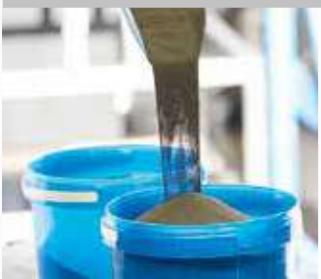
Zunächst werden Wolframkarbid, Kobalt, und Dotierkarbide nach speziellen Rezepturen verwogen. Diese Mischungen werden mehrere Stunden in Attritoren gemahlen und danach gesiebt bzw. sprühgetrocknet, um Pulver oder Granulate für die verschiedenen Fertigungstechnologien zu erhalten.
